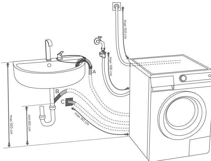
**A** Сливной шланг можно закрепить на раковине или ванне. При помощи шнура, протянутого через пластмассовый кронштейн, закрепите сливной шланг таким образом, чтобы он не соскользнул на пол.
