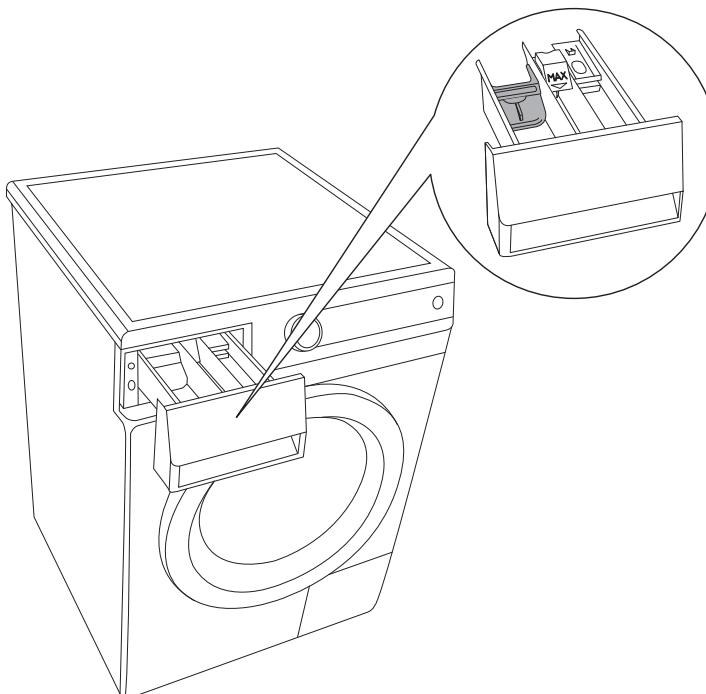
В дозаторе некоторых моделей стиральных машин предусмотрена специальная пластина, которая позволяет заливать в левое отделение дозатора жидкие стиральные средства (в зависимости от модели). Если вы используете стиральный порошок, пластина должна быть поднята вверх. Если вы используете жидкие стиральные средства, опустите пластинку.
