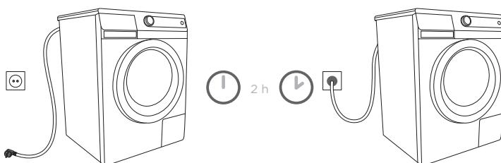
Перед первым подключением к электросети оставьте прибор при комнатной температуре на 2 часа.
