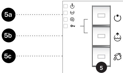
Дополнительные функции включаются и выключаются нажатием на соответствующую кнопку (до нажатия на кнопку СТАРТ/ПАУЗА). Некоторые функции для отдельных программ невозможно установить, о чем предупреждает звуковой сигнал и мигающая лампочка-индикатор (см. таблицу программ).
