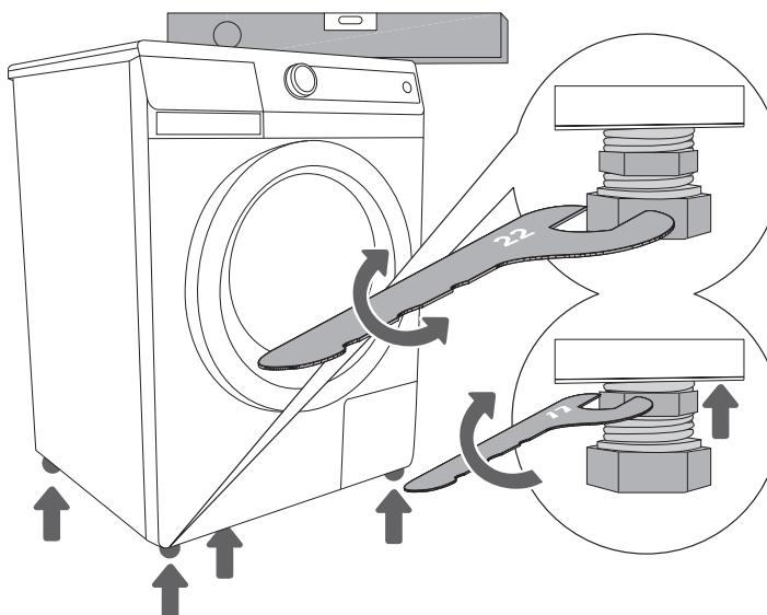
**1** Выровняйте прибор по горизонтали и по вертикали, вращая регулируемые ножки, которые позволяют выровнять прибор на  $\pm 1$  сантиметр.
