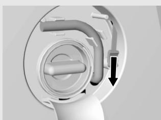
Дверцу стиральной машины можно открыть только в том случае, если уровень воды в машине низкий, в противном случае обязательно слейте воду из машины (для этого используйте дополнительную программу слияния воды ⇩ или отжим ⚡).
