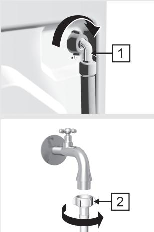
сеточкой и привинтите шланг к водопроводному крану. (В некоторых моделях уплотнитель с сеточкой уже установлен, поэтому установка уплотнителя в гайку заливного шланга не требуется.)
