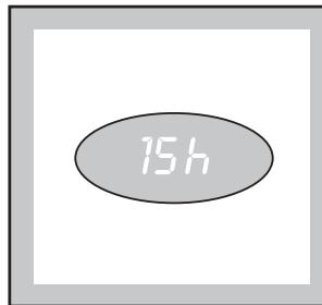
Время задержки появляется на 3 секунды, после чего высвечивается продолжительность выбранной программы. После нажатия кнопки СТАРТ/ПАУЗА начинается отсчет, и значение задержки уменьшается на одну единицу в час. Задержку включения выбранной программы можно отложить до 24 часов с интервалами в один час.
