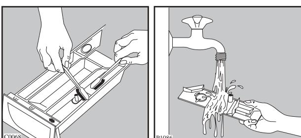
Стиральный порошок скапливается и в углублении дозатора. Для чистки углубления
