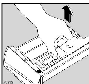
Стиральный порошок скапливается и в углублении дозатора. Для чистки углубления можно использовать старую зубную щетку. После чистки установите дозатор на место, и включите программу стирки без белья.
