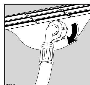
Другой конец наливного шланга, подключающийся к машине, может быть повернут в любом направлении. Ослабьте гайку, поверните шланг и вновь затяните гайку, проверив отсутствие течей воды. Наливной
