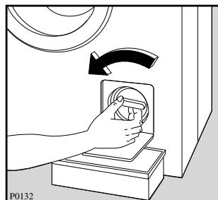
Промойте ее аккуратно проточной водой. Установите сетку на место и закройте крышку.
